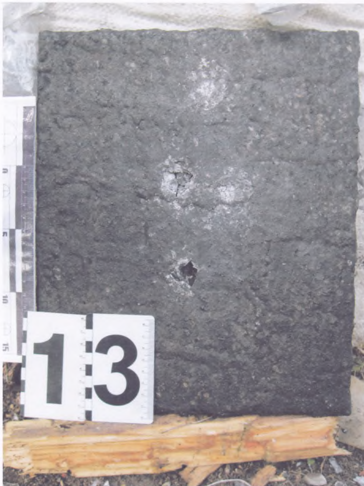
Фото №5. Загальний вигляд броні пластини після випробування. 7,62-мм гвинтівочним патроном з кулею ЛПС.
