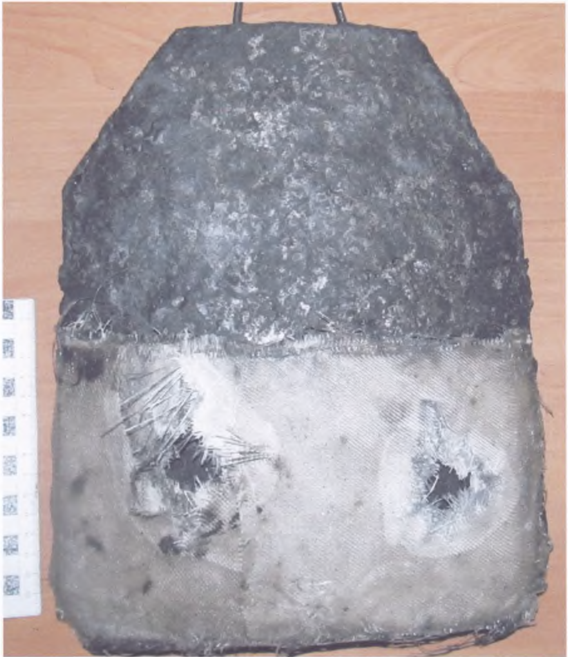
Фото №2. Загальний вигляд броне пластини після випробування(протиуламковий екран пошкоджено).
