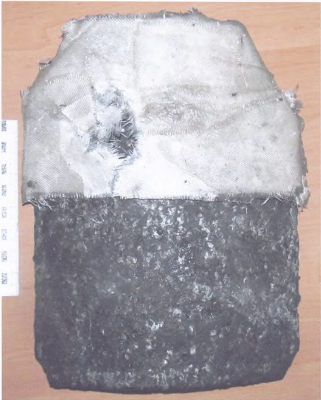
Фото №2. Загальний вигляд броне пластини після випробування(проти уламковий екран пошкоджено).
