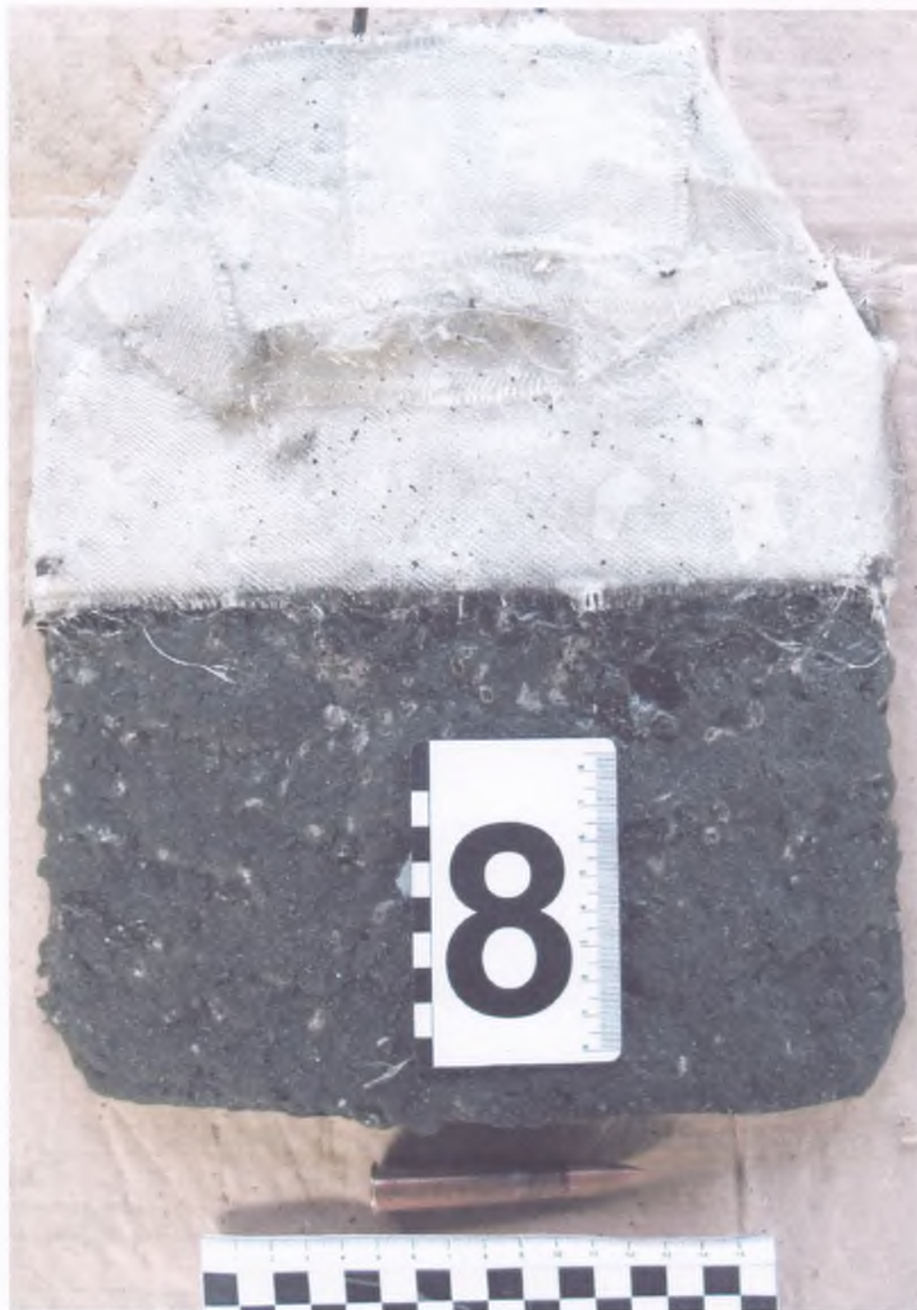
Фото №1 Загальний вигляд броне пластини перед випробуванням(зона ураження покрита протиуламковим екраном із скловолокна)
