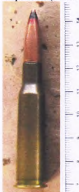
Фото №1. Загальний вигляд патрону 7,62-мм гвинтівочного патрону з бронейно-запальною кулею «Б-32» обр. 1932 (57-БЗ-322), який використовувався при експериментальній стрільбі.
