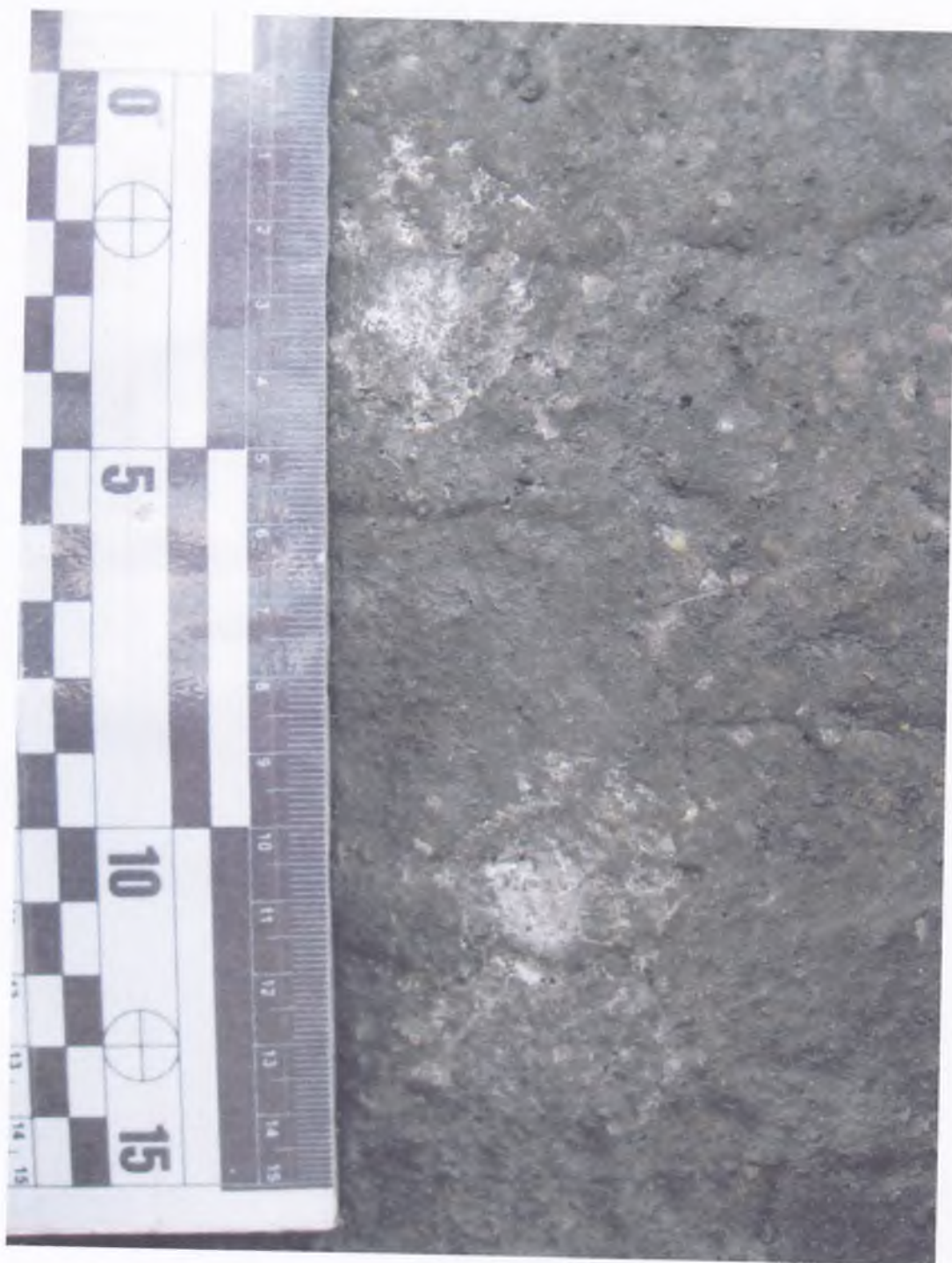
Фото №4. Збільшений вигляд ушкоджень броне пластини після випробування 5,45мм набоями до АК-74.
