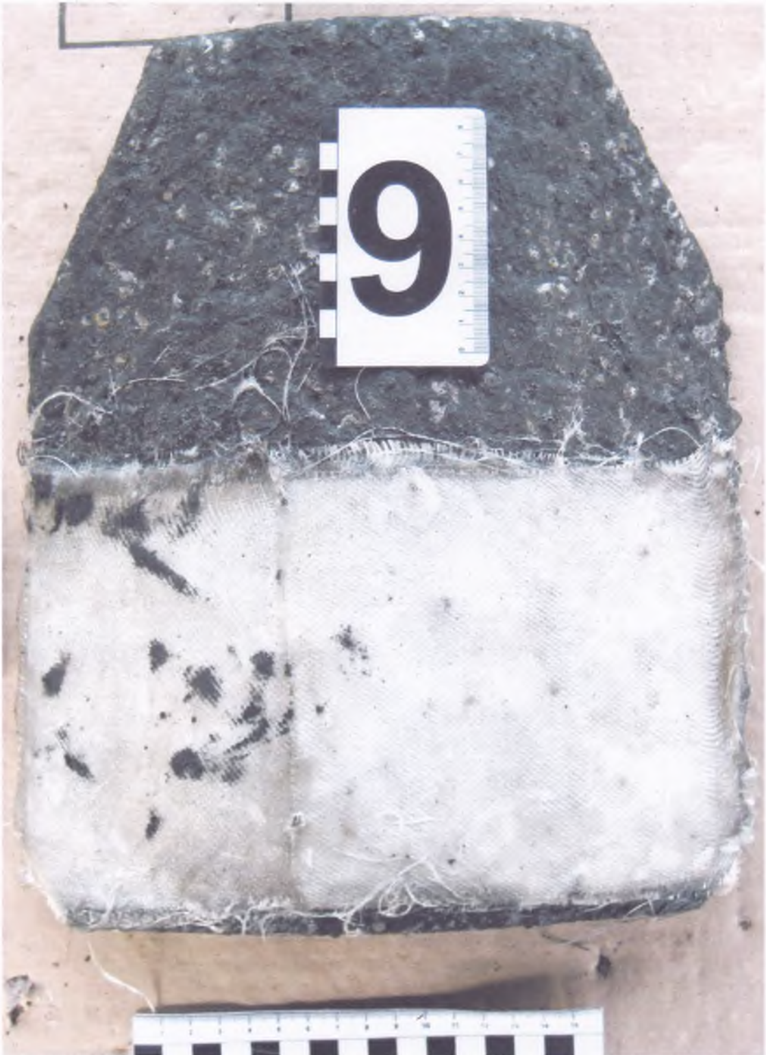
Фото №1 Загальний вигляд броне пластини перед випробуванням(зона ураження покрита протиуламковим екраном із скловолокна)
