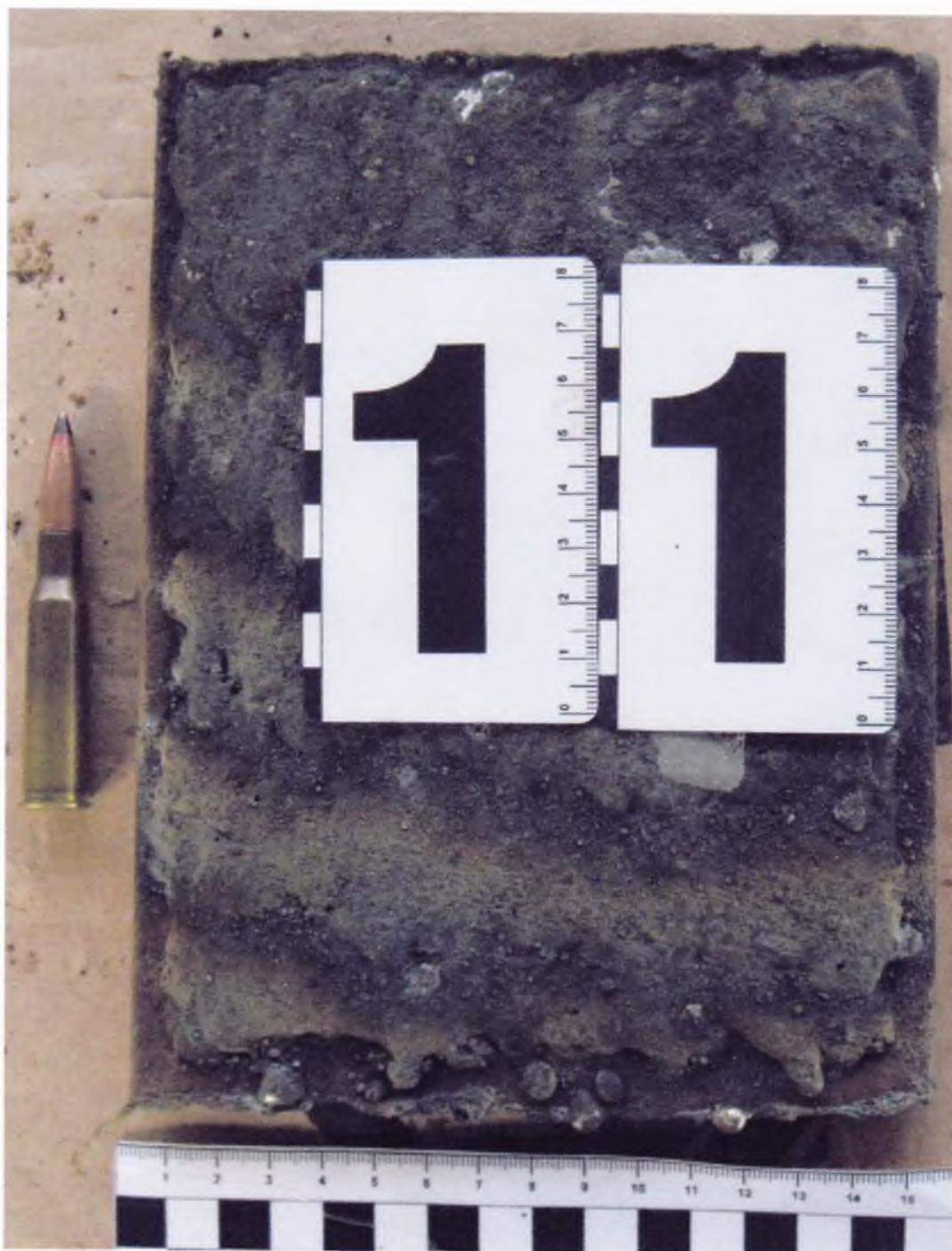
Фото №1 Загальний вигляд другої бронепластики перед випробуванням та 7,62-мм гвинтівочний патрон з кулею Б-32 поряд з нею.
