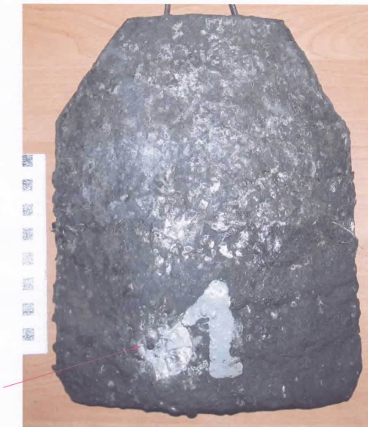
Фото №3. Загальний вигляд броне пластини після випробування(протиуламковий екран знятий, стрілкою показане осердя, що застрягло у пластині).
