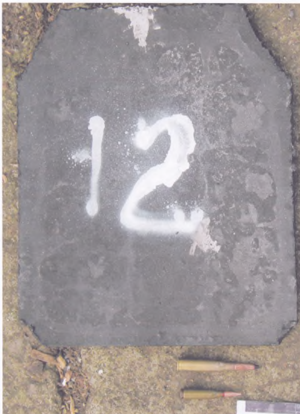
Фото №2. Загальний вигляд зворотної сторони бронепластики перед випробуванням та 7,62-мм гвинтівочний патрон з кулею Б-32 з 5,45-мм патроном до АК-74 поряд з нею.
