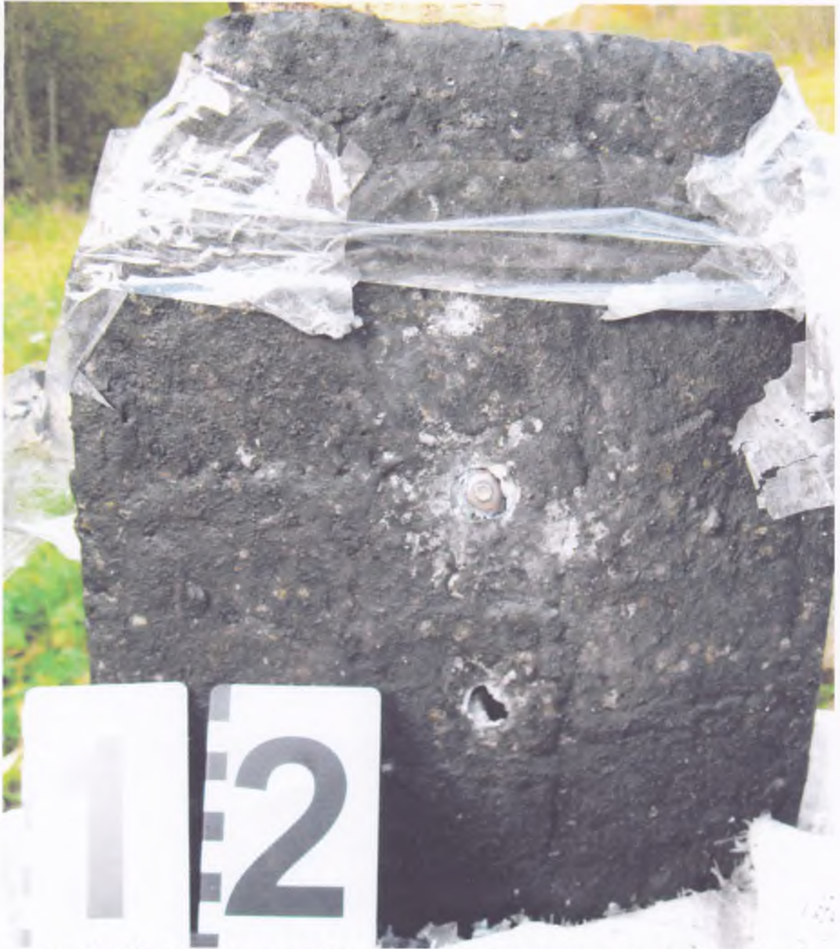
Фото №5. Загальний вигляд броне пластини після випробування. 7,62-мм гвинтівочним патроном з кулею Б-32 .
