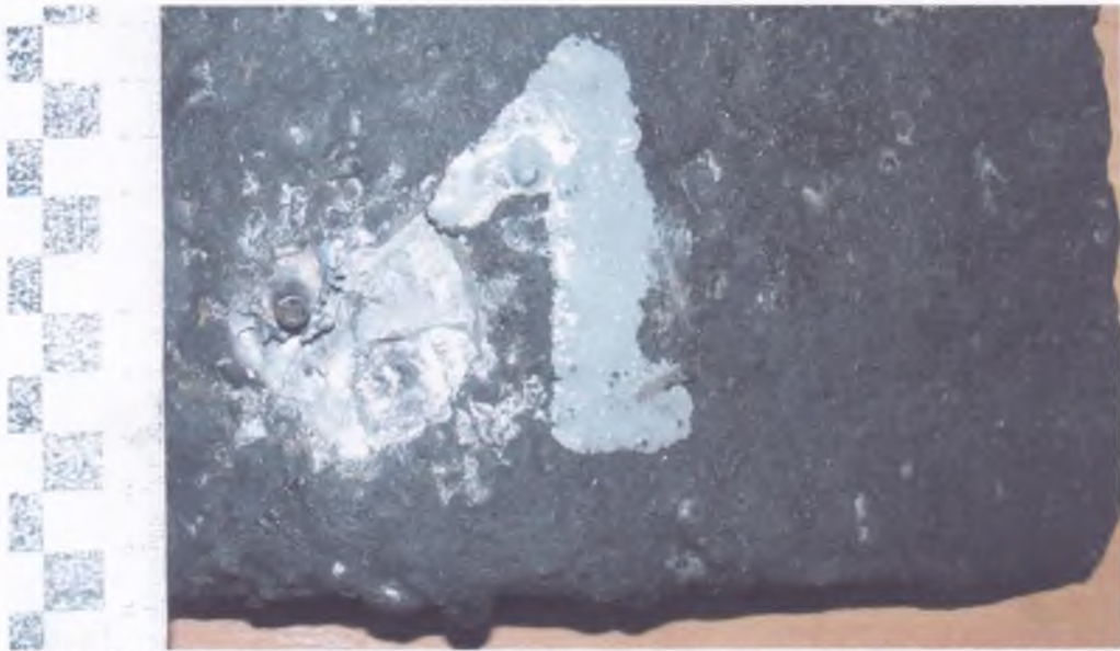
Фото №5. Загальний вигляд ушкодження пластини кулею ЛПС під протиуламковим екран.
