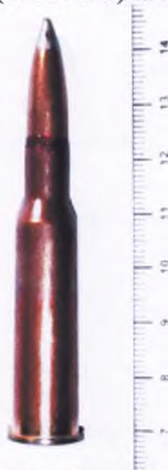
Фото №1. Загальний вигляд патрону 7,62-мм гвинтівочного патрону з кулею «ЛПС» зі сталевим сердечником (57-Н-323С), який використовувався при експериментальній стрільбі.
