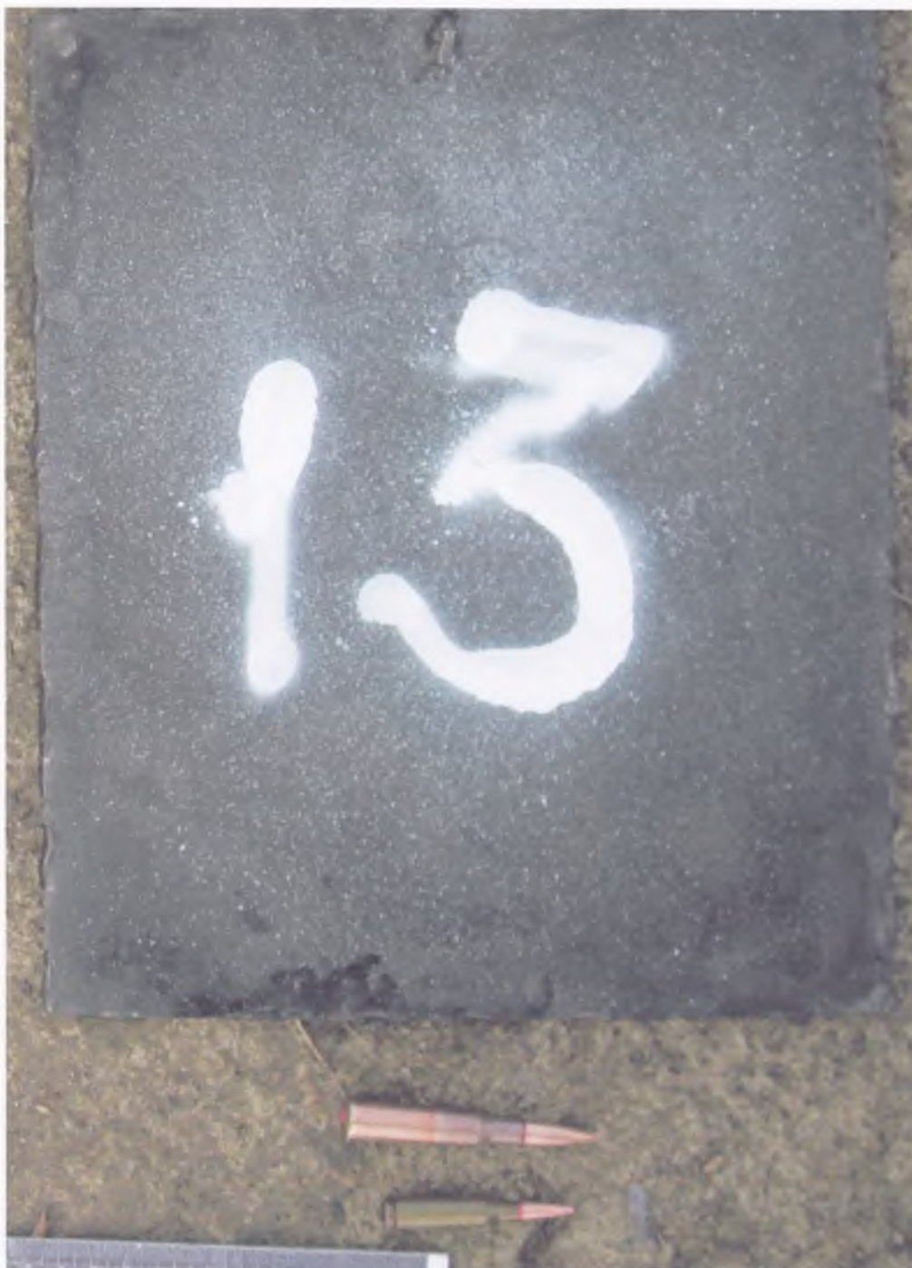
Фото №2. Загальний вигляд зворотної сторони бронепластики перед випробуванням та 7,62-мм гвинтівочний патрон з кулею ЛПС з 5,45-мм патроном до АК-74 поряд з нею.
