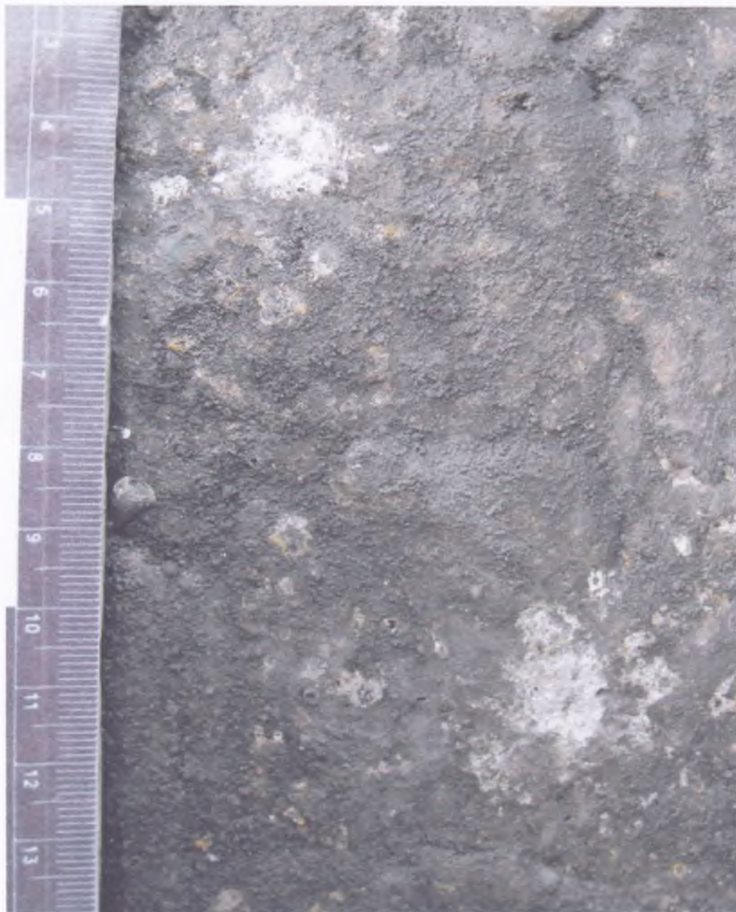
Фото №4. Збільшений вигляд ушкоджень броне пластини після випробування 5,45мм набоями до АК-74.
