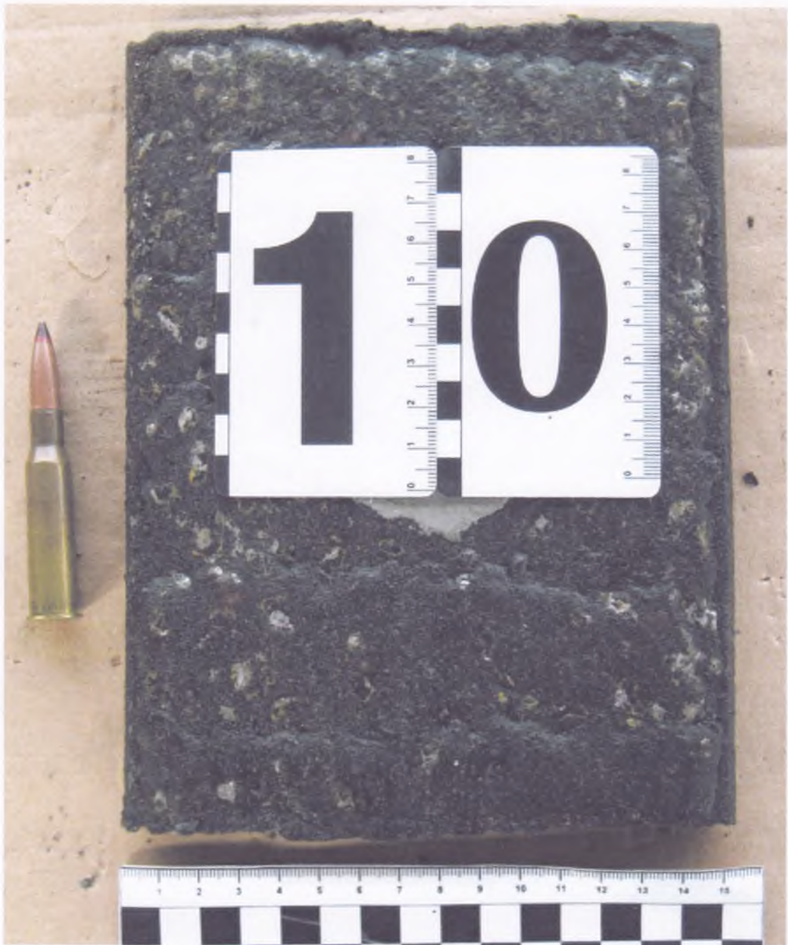
Фото №1 Загальний вигляд бронепластини перед випробуванням та 7,62-мм гвинтівочний патрон з кулею Б-32 поряд з нею.
