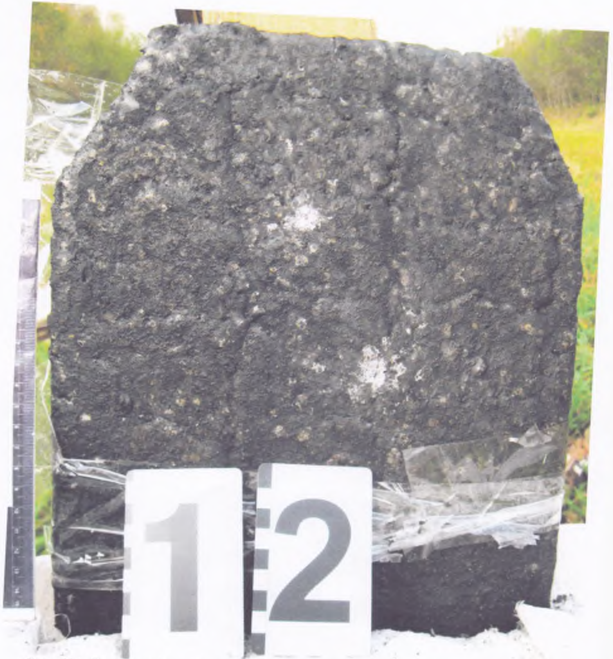
Фото №3. Загальний вигляд броне пластини після випробування 5,45мм набоями до АК-74.
