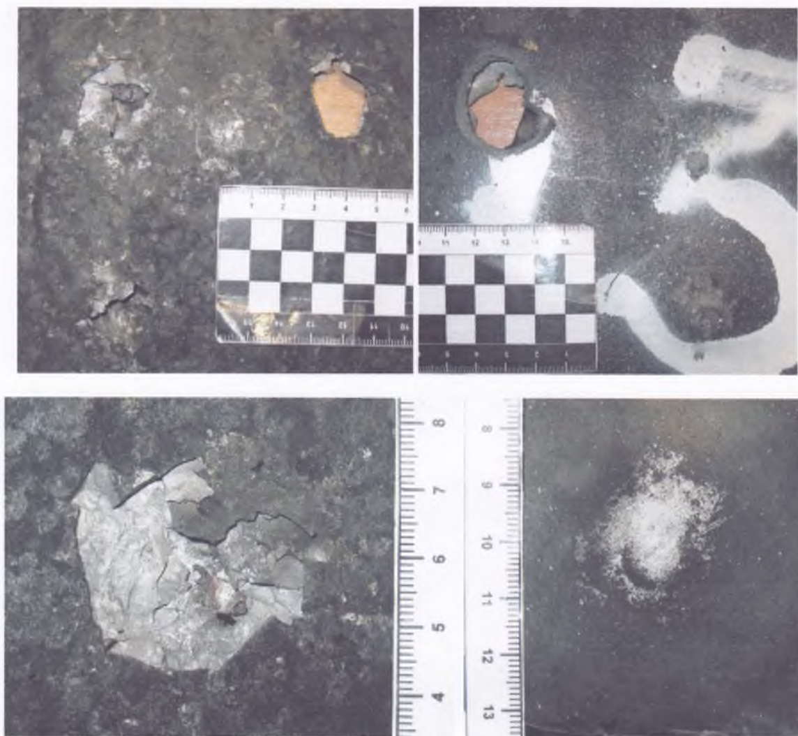
Фото №6-9. Загальний вигляд ушкодження пластини 7,62-мм кулею ЛПС.
