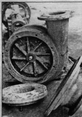
Фото 2. Шламмовий насос ШН-270. Робоче колесо та бронедиск виробництва ТзОВ МНВЦ «Епсілон АТД» додатково зміцнені електродуговим наплавленням електродами (стрічкою) ЕП-ТБ-2-40. Твердість покриття 67-69 HRC.
